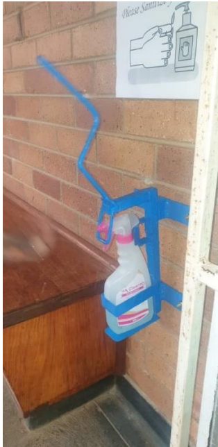
Handfreier Sanitizer für Rollstuhlfahrer (mit dem Ellbogen bedient), hergestellt von einem ehemaligen
